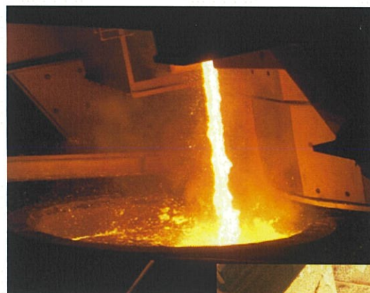
電気炉からの 溶鋼出鋼 ( \geq 1600^{\circ}\text{C} )
